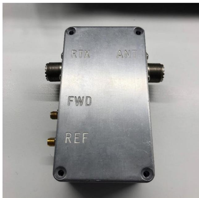
Sulle due uscite, diretta FWD e riflessa REF sono stati inseriti due circuiti di attenuazione per rendere i livelli idonei alla scheda della CPU. Il rapporto dei due trasformatori inseriti è di 24:1 e l'attenuazione totale è di circa 27,6 dB.
